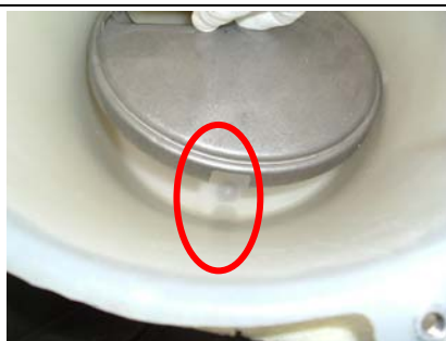
13 Lors du remontage, veillez à emboîter l'encoche du double fond dans le bossage de la cabine de stockage
