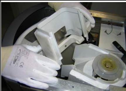
9 Heben Sie an und entfernen Sie Sortierfachabdeckung
