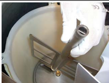
10 Entfernen Sie Sortierfachschaufel
