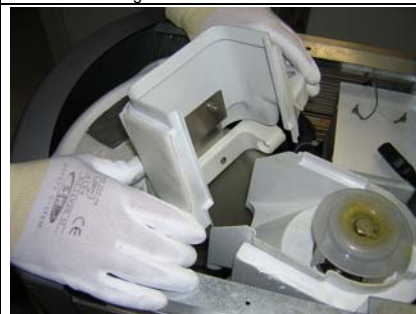
9 Démontez le couvercle du bac de stockage avec cellules de niveau de glace
