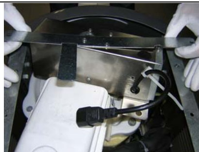
7 Sollevare il motore elettrico e l'assieme supporto
