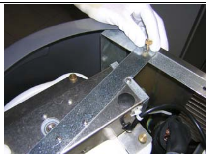
5 Dévisser les vis de fixation du support moteur de distribution
