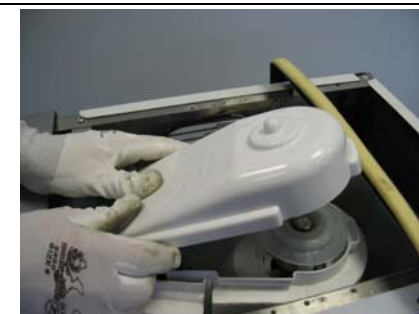
8 Démontez le couvercle du bec verseur
