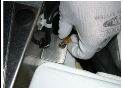
6 Entfernen Sie die Sortierfachabdeckung, die die Schrauben hält
