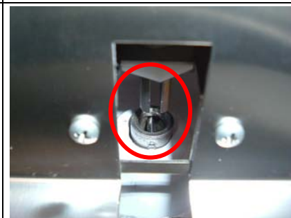
14 Beachten Sie dass die Gleichantriebs motorwelle mit der sortierfach schaufel welle stift übereinstimmen muss wenn der antriebsmotor wieder zurückgestellt wird.
