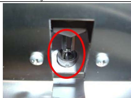
14 Pour le remontage du moteur de distribution à emboîtement par clavetage, veillez à bien emboîter l'axe du moteur de distribution dans l'axe femelle de la pale
