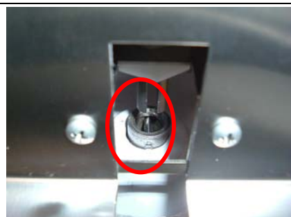
14 Allineare correttamente l'albero del motore elettrico con il perno centrale dell'albero della pala quando si riposiziona l'assieme motore
