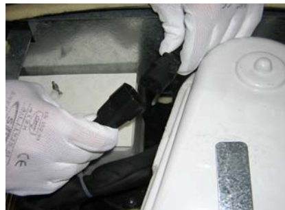
4 Trennen Sie die Antriebsmotoranschlüsse
