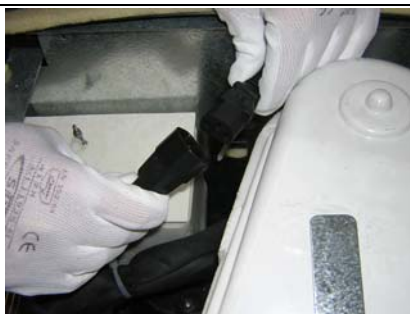
4 Débrancher la fiche du moteur électrique de distribution de glace
