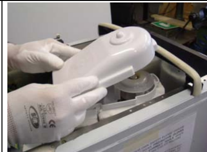
8 Entfernen Sie Tülleplastikabdeckung
