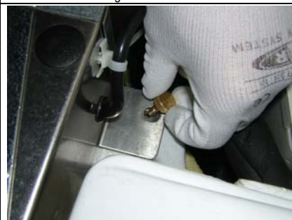
6 Dévisser les vis du couvercle du bac de stockage
