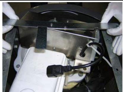
7 Heben Sie Antriebsmotor und Haltewinkel an
