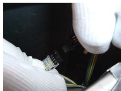
3 Débrancher le connecteur de la sonde de niveau de glace
