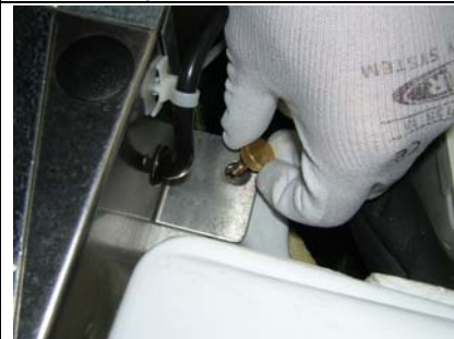
6 Rimuovere le viti di ancoraggio del coperchio del deposito
